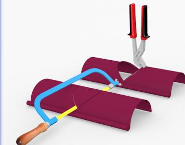
Отрежьте два косых куска так, чтобы получить отверстие. Отогните края отверстия для улучшения стока воды.
