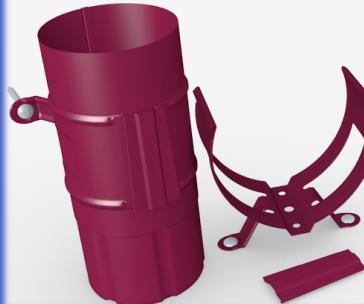
Стандартное крепление хомута трубы производится через отверстия в лапках хомута. Края хомута, после установки в него трубы, нужно плотно сжать и зафиксировать клином.
