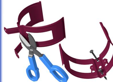
Для установки хомута крепления трубы вплотную к поверхности нужно отрезать лапки, а для крепления хомута к поверхности использовать отверстия, расположенные в центре по краям.
