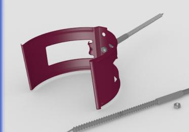
Если нет возможности закрепить хомут трубы на поверхность стены, то для дистанционного крепления хомута можно использовать шпильку, а хомут закрепить на ней с помощью центрального отверстия.
