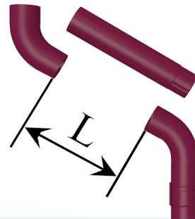
Для отвода трубы от карниза к стене используйте колено и отрезок трубы. Замерьте расстояние между краем колена, одетого на воронку, и краем колена, одетого на трубу, которая крепится к стене L. Отрежьте отрезок трубы на 10 см длиннее (L+10cm).
